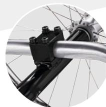
Verstellbares Oversize-Achsrohr zur idealen Schwerpunkteinstellung
