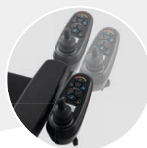
Fahrelektronik längs- und höheinstellbar
